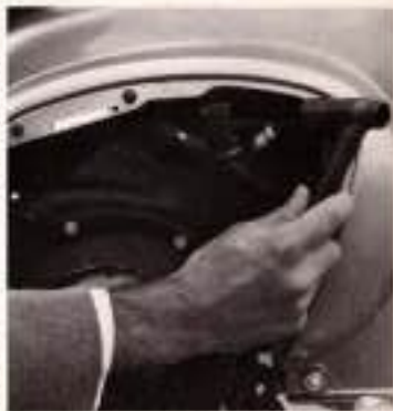
Fig. 11 Desmontaje de la bujía.
