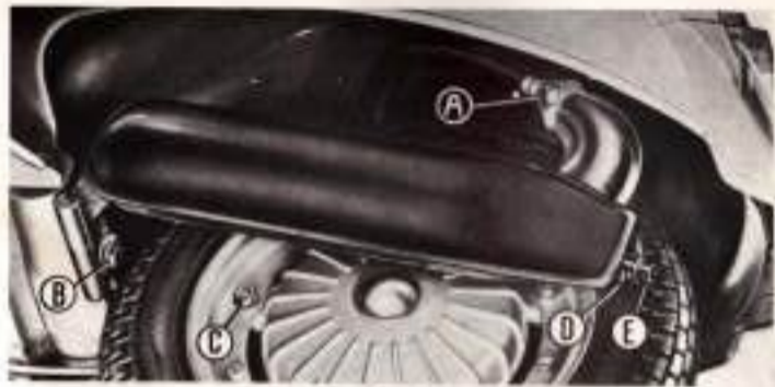
Fig. 16 Desmontaje rueda trasera del vehículo. Para desmontar el tubo «E» del silenciador quitar el tornillo de sujeción «D».
