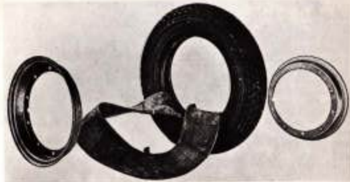
Fig. 17 Desmontaje del neumático.
